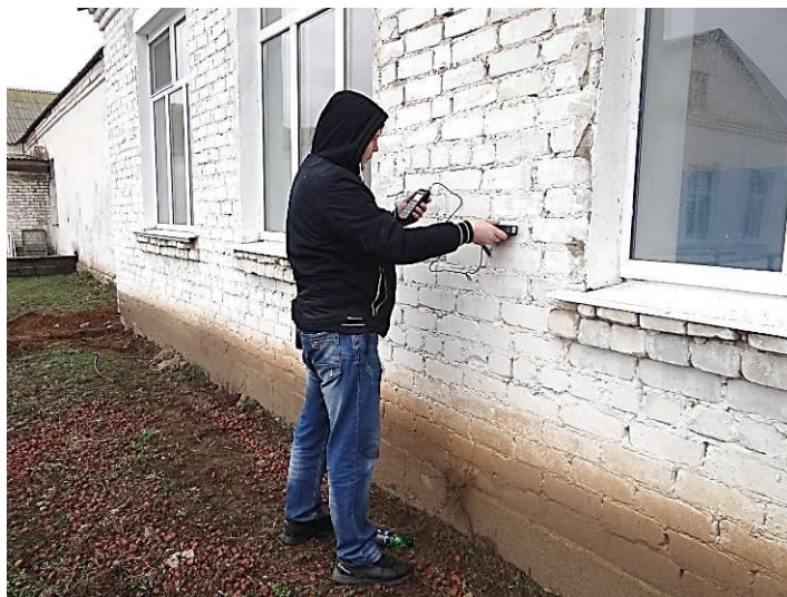
Фото 8. Определение армирования кирпичной кладки
